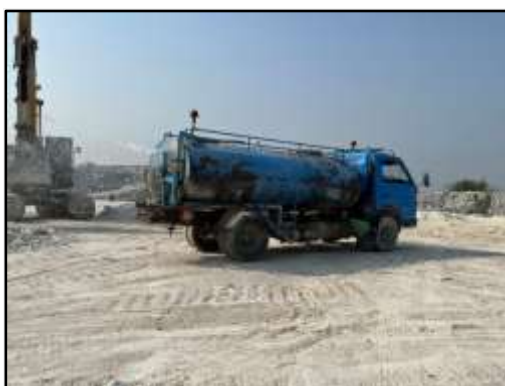
รูปที่ 2-10 การฉีดพรมน้ำบริเวณที่เกิดฝุ่นละออง ทั้งบริเวณหน้าเหมือง และเส้นทางขนส่งภายในพื้นที่ เพื่อลดการฟุ้งกระจายของฝุ่นละออง
